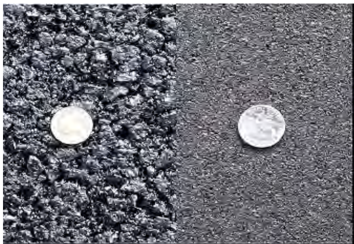
Figure 3–4 : Surface mince de tapis d'enrobés mélangés à chaud à gauche; surface de mélange sableux à droite. Les pièces de monnaie ont un diamètre de 18 mm.
